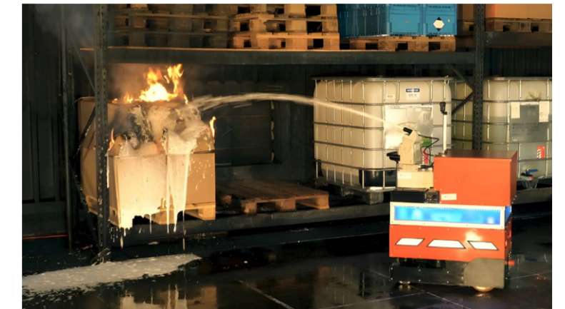
Roboter im Einsatz: Modularer autonomer Roboter löscht Hochregallager
