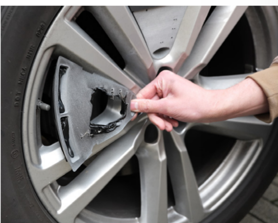
„Prototyp eines Kunststoff-Inserts: Testversuche auf dem Rollenprüfstand“
